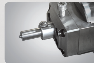
Sabitlenen Abutment ve Jig'i ekipmana yerleştirme
